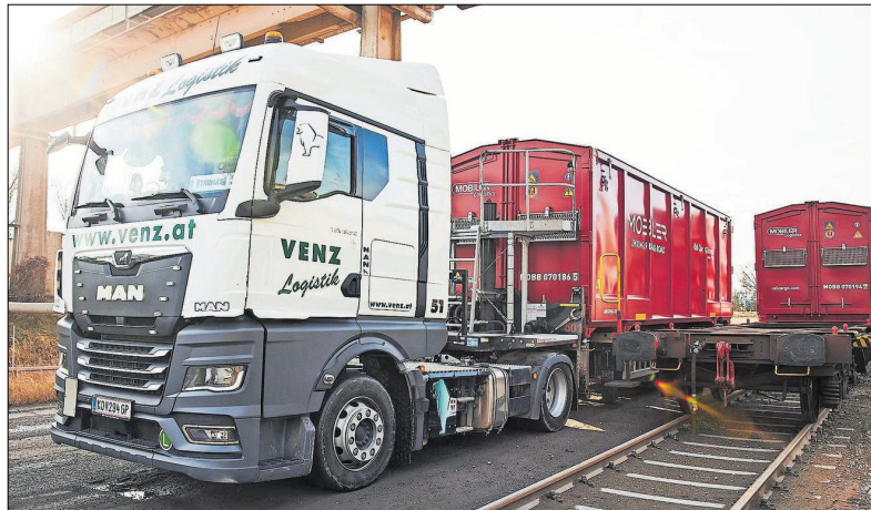
„Mobiler“ ermöglichen den einfachen Containerumschlag durch eine einzelne Person ohne besondere Verladebahnhöfe vom Lkw auf den Waggon und umgekehrt. [RCG]
